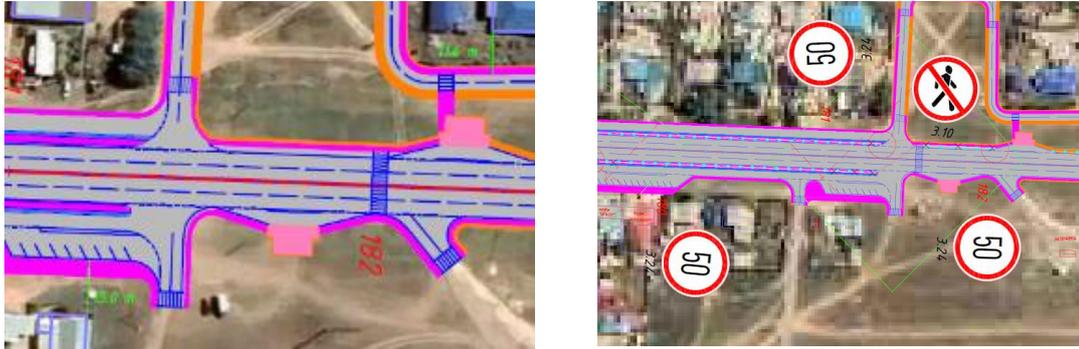
Рисунок 40 - Смещение горизонтальной разметки пешеходного перехода
