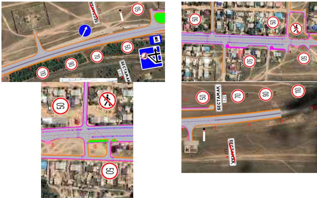
Рисунок 21 – Схема скоростного режима
