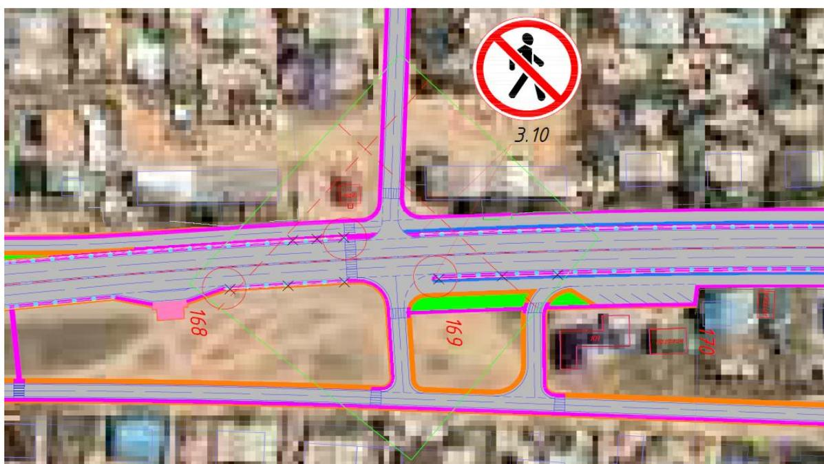
Рисунок 43 - Схема исключения объёмов шумозащитных экранов, с максимальной возможностью обеспечения видимости на пересечении ПК168-ПК169
