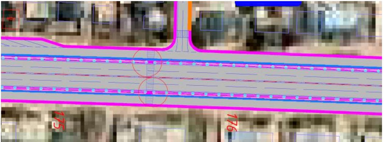
Рисунок 46 - Участок с дополнительной установкой шумозащитного экрана по факту исключения примыкания к основной проезжей части
